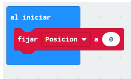
Figura 55. imagen de fijar la posición inicial para el servo
