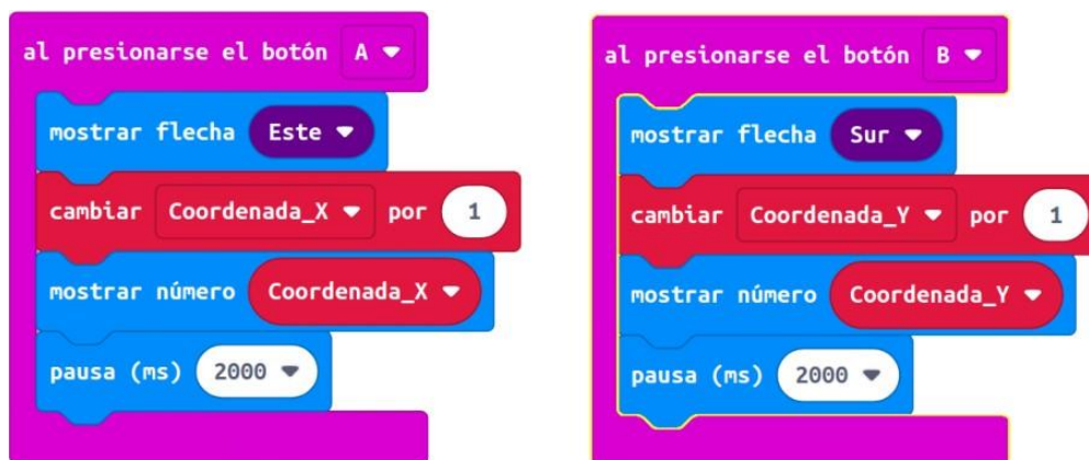
Figura 87. los botones A y B simulan el aumento de las cordenadas de uno en uno
