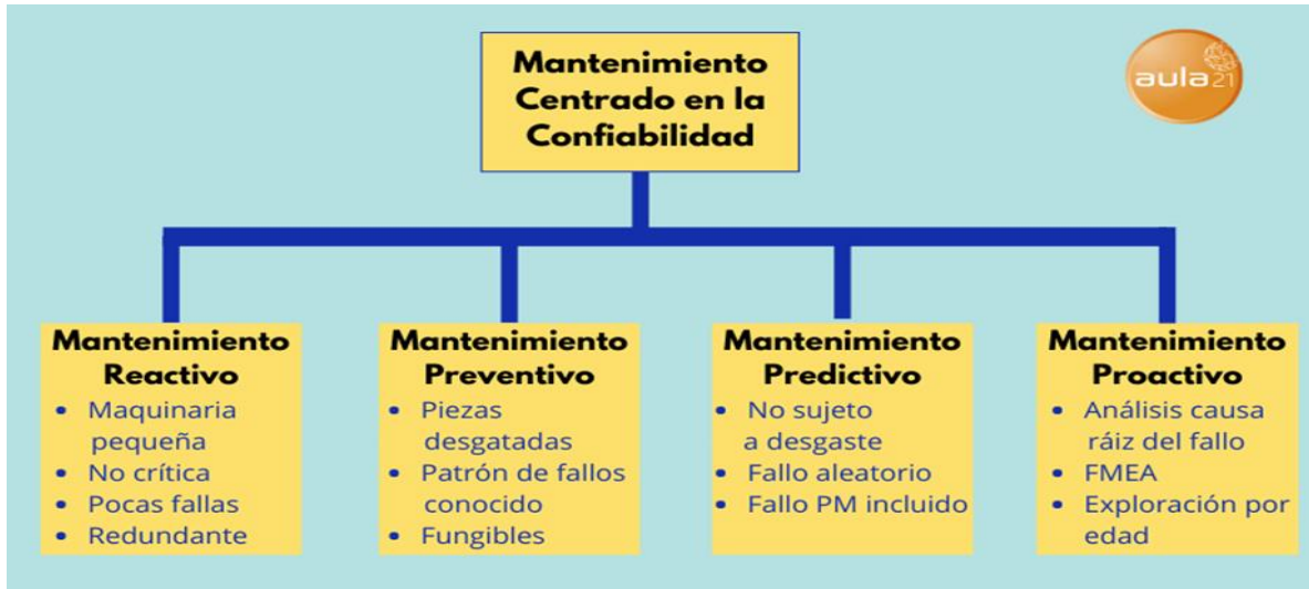
Imagen 12 Mantenimiento centrado en confiabilidad
