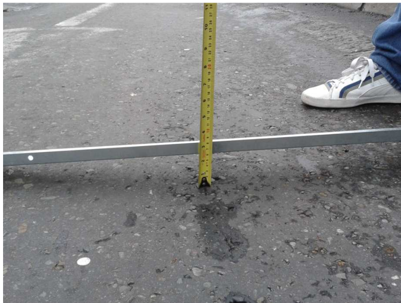
Foto 20. Detalle Ahuellamiento del pavimento en la carrera 52 con calle 85 Costado oriental, profundidad 6 cm. Vía objeto de estudio.
