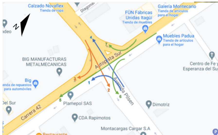
Figura 5. Maniobres identificadas en la intersección (autopista sur con avenida Pilsen). Tomada de Elaboración propia sobre un mapa base tomado de Google Maps, (2019)
