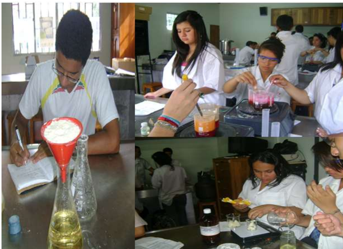
Ilustración 6 : Laboratorio de saponificación, proceso de separación del jabón mediante filtración.
