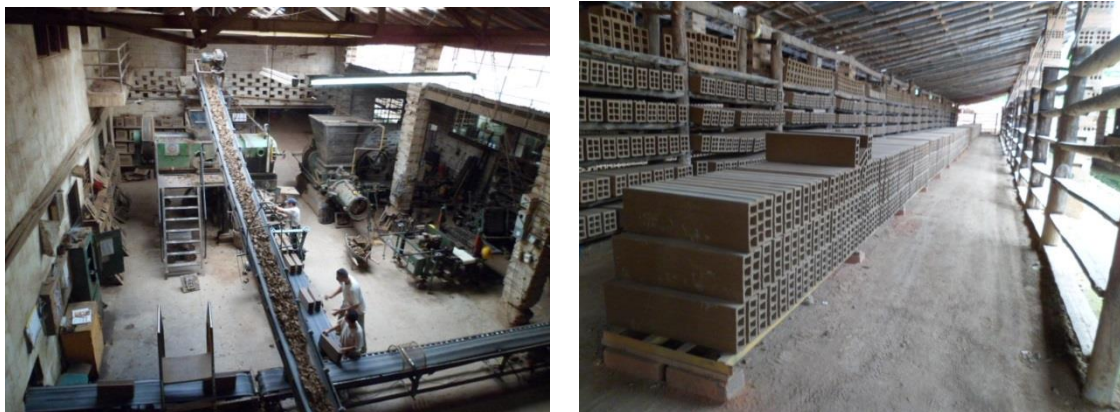
Figura 21. Fotografías de los Procesos de producción, secado y almacenamiento de materiales cerámicos. Fuente: Fotografías tomadas en visitas de campo realizadas al Área de Planificación.
