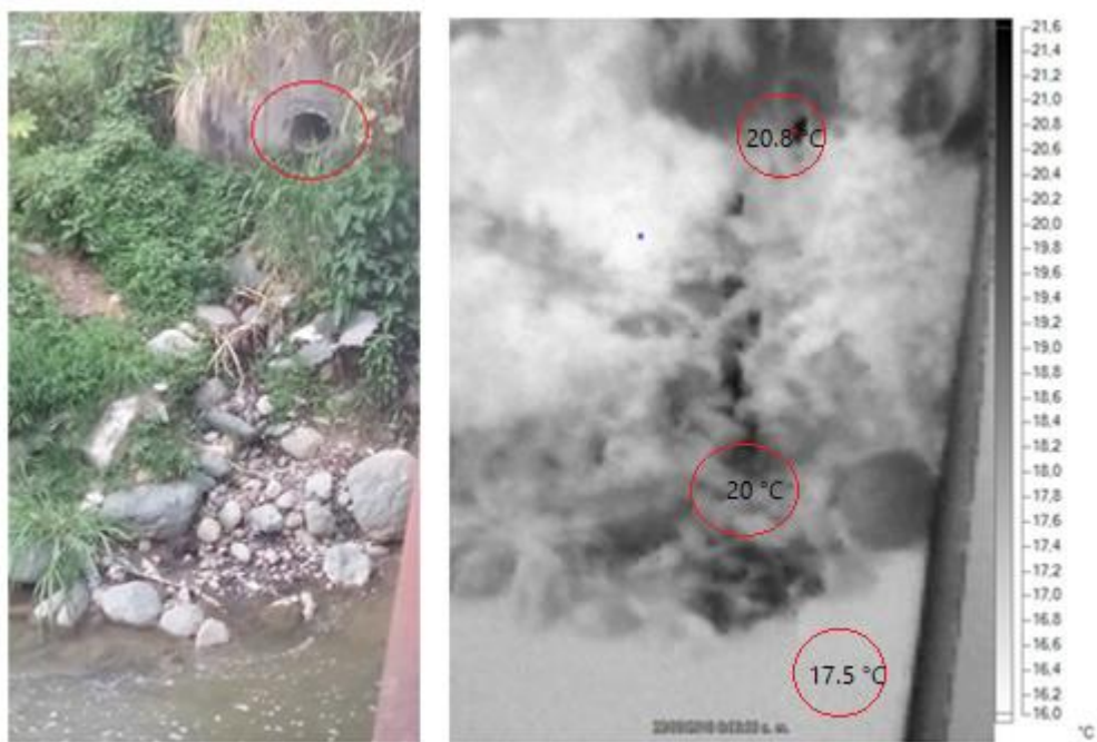
Foto 7: Vertimiento de agua residual en la quebrada Doña María (imagen RGB izquierda, térmica derecha)
